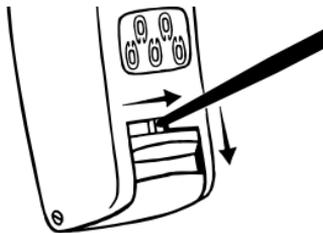
Замок открывается с помощью нажатия вправо и вниз с помощью инструмента, как показано на рисунке.
