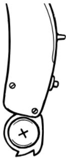
Когда Вы не используете слуховой аппарат, следует оставлять батарейный отсек открытым, чтобы слуховой аппарат проветривался.
