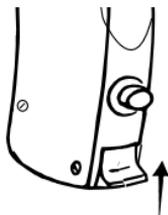
Нажмите на переключатель вверх, чтобы включить слуховой аппарат. Звуковой индикатор сообщит, что слуховой аппарат включен, если эта функция не отключена.
