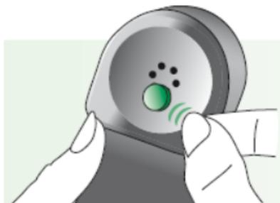
Тщательно протрите телефонную трубку. Держите трубку вертикально, как при обычном телефонном разговоре. Поднесите магнит к динамику трубки и отпустите его. Магнит автоматически прикрепится к трубке нужной стороной.
