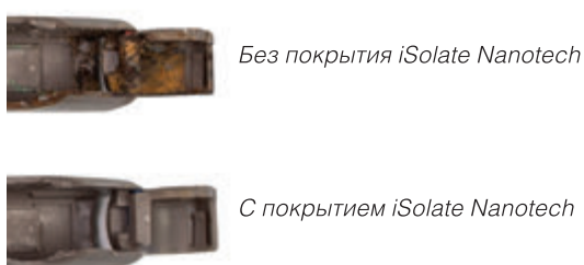
Рисунок 4. Эти два аппарата подвергались воздействию экстремальных условий окружающей среды на протяжении нескольких недель. Нижний слуховой аппарат имеет защитное покрытие iSolate nanotech и на нем не наблюдалось каких-либо повреждений. Верхний аппарат без защитного покрытия и на нем в результате наблюдались значительные следы коррозии.
