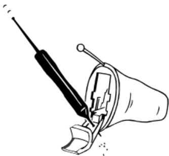
Проденьте короткий конец инструмента для удаления серы номер 3 через вход микрофона на батарейном отсеке, как показано на рисунке .
