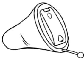
Батарейный отсек слухового аппарата совмещает функции переключателя Вкл./Выкл.
