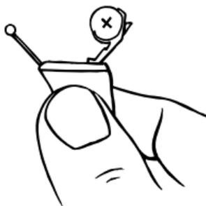
Когда Вы не используете слуховой аппарат, следует оставлять батарейный отсек открытым, чтобы слуховой аппарат проветривался.
