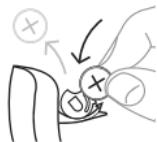
Теперь расположите батарейку в батарейном отсеке так, как показано на рисунке. Закройте батарейный отсек. Если батарейка вставлена правильно, то батарейный отсек закрывается без усилий. Если вы не будете использовать слуховой аппарат несколько дней, достаньте из него батарейку.
