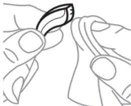
После использования слухового аппарата протрите его салфеткой (например, той, которую вы получили вместе со слуховым аппаратом). Если входы микрофонов по-прежнему заблокированы, обратитесь к своему специалисту.
