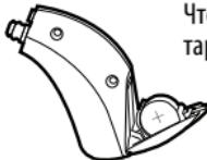
Чтобы выключить слуховой аппарат, надавите на крышку батарейного отсека вниз.
