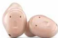
WIDEX UNIQUE ITE основан на новой платформе U от WIDEX с технологией классификации звуков, которая автоматически классифицирует звуковое окружение и оптимально обрабатывает звук в зависимости от звукового класса.
